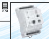
HRH-1 4 toimintoa, erikoisasettelut eri yhdistelmille, galvaanisesti erotettu syöttö 230VAC tai 24V AC/DC, 2 lähtökosketinta 16A.
