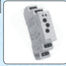
CRM-93H 10 toimintoa, 10 aika-alueetta, 3x16A vaihtokosketin, syöttö 12-240VUC tai 230VAC
