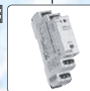
TER-7 Moottorikäimien lämpötilanvalvontaan sisään rakennetun PTC-terministin resistanssialueen rajoissa (1.8-3.3 kΩ), lisätoiminto (muisti, nollaus), lähtökoskettimet 2x8A vaihto, Syöttö: 24-240V AC/DC.
