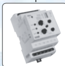
TER-4 Laaja ja tarkka asettelualue -40 ... +110 °C (-40 °F ... 230 °F) jaettuina 10:een alueeseen yhdessä laitteessa, lämpötilan hienosäädöllä. 2 tuloa NTC-anturille, 2 lähtöä 16A vaihtokoskettimella, lisätoiminnot (muisti, hystereesi, vioittuneen anturin ilmaisu). Syöttö: 230VAC tai 24V AC/DC (galv. erotettu).
