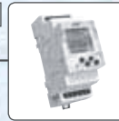
TER-9 Digital multifunction thermostat 2 lämpötilatuloa, 2 lähtöä 8A vaihto, 6 toimintoa, sisäänrakennettu kellokytin, LCD-näyttö taustavalolla, galvaanisesti erotettu syöttö 230VAC tai 24V AC/DC, 2 moduulia. Lämpötila-alue: -40 °C ... +110 °C / -40 °F ... 230 °F
